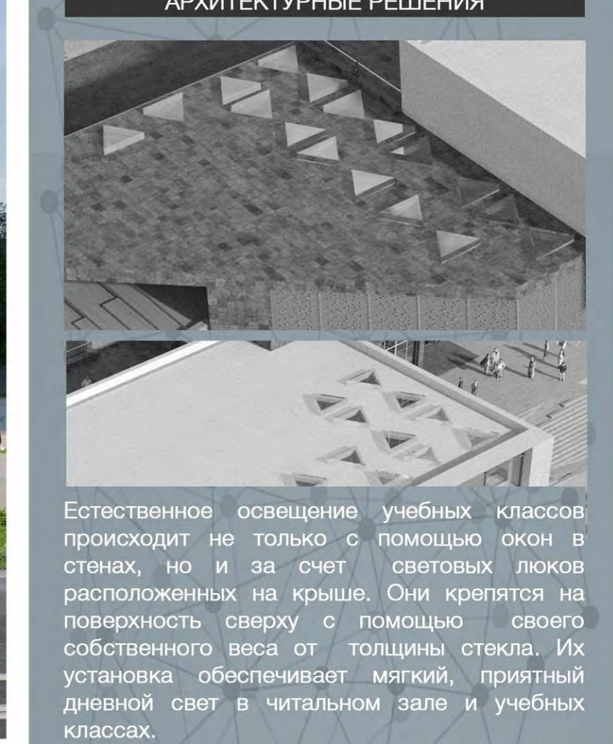
Естественное освещение учебных классов происходит не только с помощью окон в стенах, но и за счет световых люков расположенных на крыше. Они крепятся на поверхность сверху с помощью свода собственного веса от позиции стоек. Их установка обеспечивает мягкий, приятный дневной свет в читальном зале и учебных классах.
