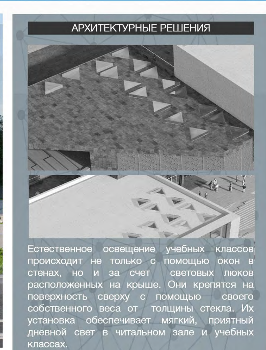
Естественное освещение учебных классов происходит не только с помощью окон в стенах, но и за счет световых люков расположенных на крыше. Они крепятся на поверхность сверху с помощью свода собственного веса от позиции стоек. Их установка обеспечивает мягкий, приятный дневной свет в читальном зале и учебных классах.
