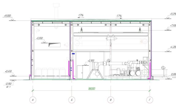
Здание предназначено для размещения насосов и представляет собой прямоугольный объем с шагом колонн 6 метров. Размеры здания в плане в осях 36 x 18 метров. Высота от уровня чистого пола до низа конструкции покрытия в основном объеме составляет 7,5 метров.
