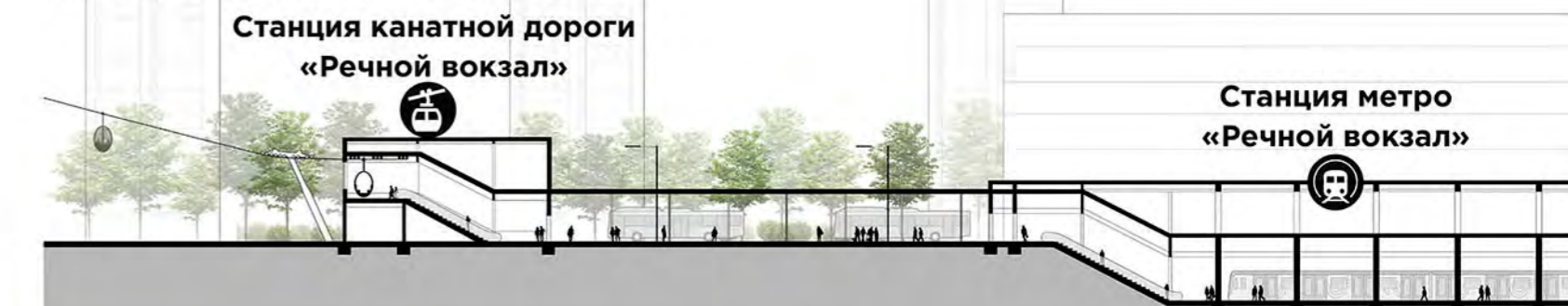
СХЕМА ПЕРЕСАДКИ МЕЖДУ СТАНЦИЯМИ МЕТРО «РЕЧНОЙ ВОКЗАЛ» И КАНАТНОЙ ДОРОГИ «РЕЧНОЙ ВОКЗАЛ»
