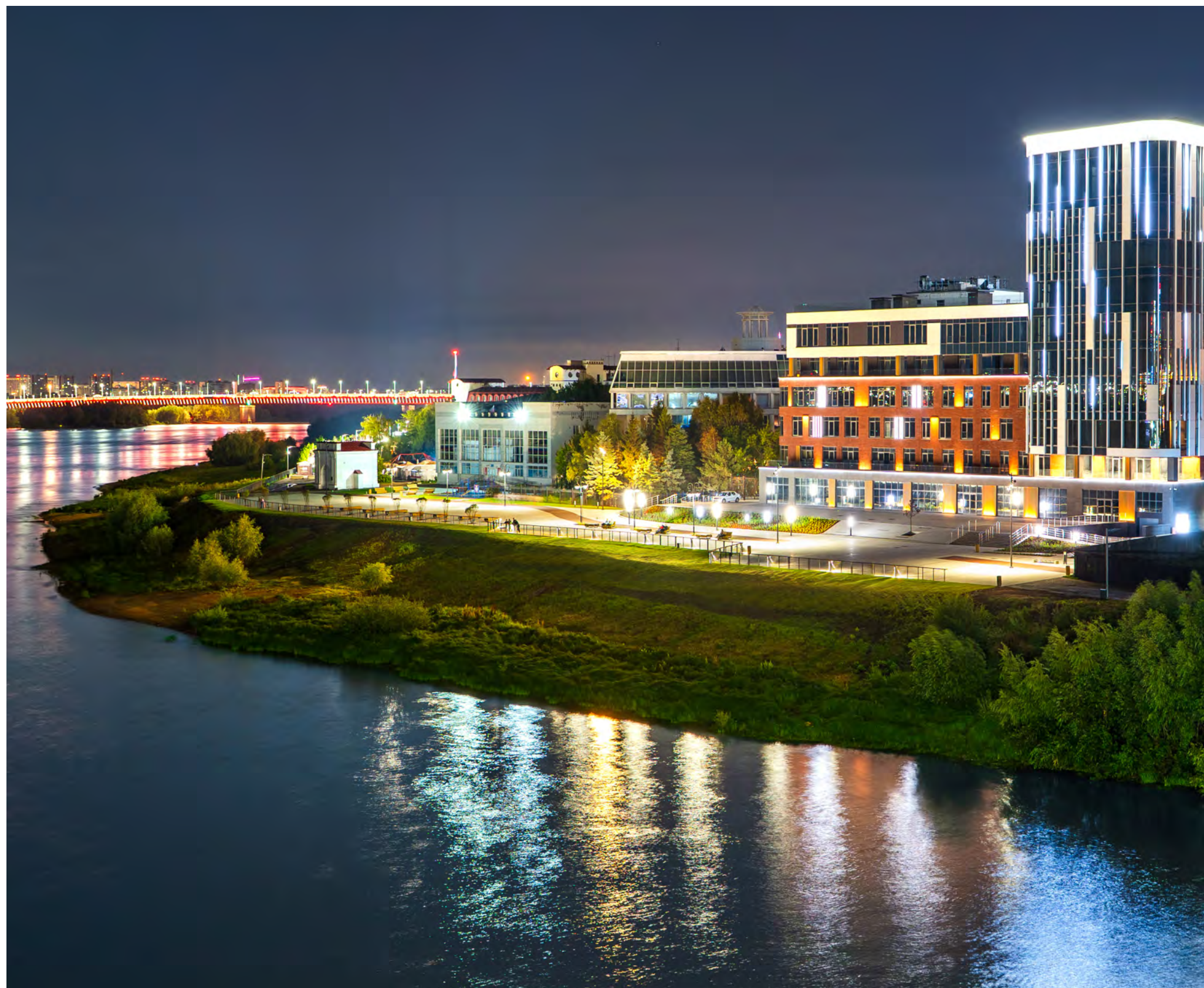
ЯРУСНОЕ ОСВЕЩЕНИЕ - ОТ ЛАНДШАФТНОГО СВЕТА У ОТКОСА И ОГРАЖДЕНИЯ, ФОНАРИ ВДОЛЬ АЛЛЕИ И НА ПЛОЩАДКАХ, АКЦЕНТНЫЙ СВЕТОВОЙ ВАЛ ПРОДОЛЖАЕТ ВЕРТИКАЛЬНУЮ ПОДСВЕТКУ ЗДАНИЯ.
